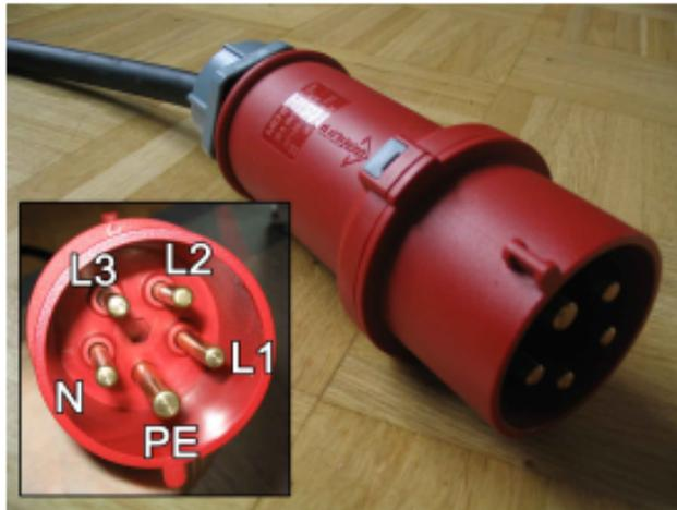
Die Wechselspannungen  $U_k(t)$ ,  $k = 1, 2, 3$ , zwischen  $L_k$  und dem Neutralleiter  $N$  erreichen ihre maximale Auslenkung zeitlich um je eine Drittelperiode versetzt, und sind gegeben durch
