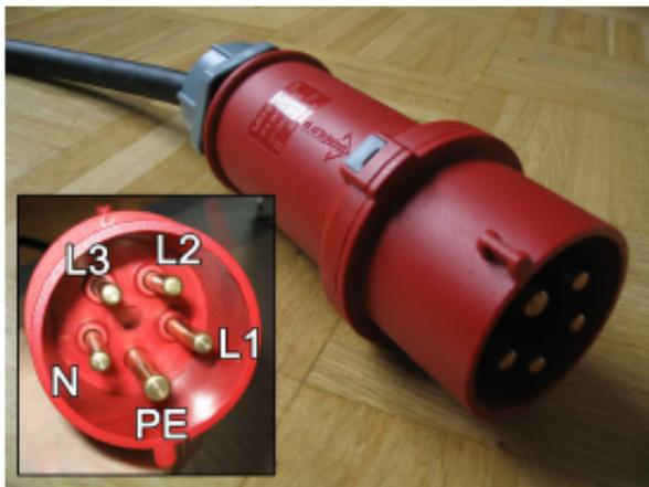
Als Dreiphasenwechselstrom oder Drehstrom wird ein System von drei miteinander verketteten Wechselströmen bzw. Wechselspannungen bezeichnet. Die Abbildung zeigt eine typische Steckdose, welche man auf jeder deutschen Baustelle oder Schreinerwerkstatt findet. In dieser sind drei Leiter  $L_k$ ,  $k = 1, 2, 3$ , und ein Neutraleiter  $N$  sowie eine Schutzerdung  $PE$  eingezeichnet.
