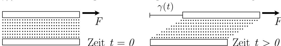
Für zwei verschiedene Materialien  $M_1$  und  $M_2$  ist das Ergebnis des Versuches in das Diagramm "Versuch 1" eingezeichnet. In einem zweiten Experiment wird die obere Platte ab dem Zeitpunkt  $t = 0$  so lange verschoben, bis  $\gamma(t)$  konstant  $1\text{cm}$  beträgt. Die dafür benötigte Kraft zum Zeitpunkt  $t$  wird mit  $F(t)$  bezeichnet. Für zwei neue Materialien  $M_3$  und  $M_4$  ist das Ergebnis des Versuches in das Diagramm "Versuch 2" eingezeichnet.
